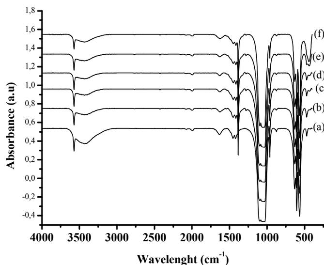
Fig. 2: FT-IR spectra of CaHAp and  $x\text{Ni}/\text{CaHAp}$  for (a)  $x = 0.5$ ; (b)  $x = 1.25$ ; (c)  $x = 2.5$ ; (d)  $x = 5$ ; (e)  $x = 10$ ; (f)  $x = 20$ .
