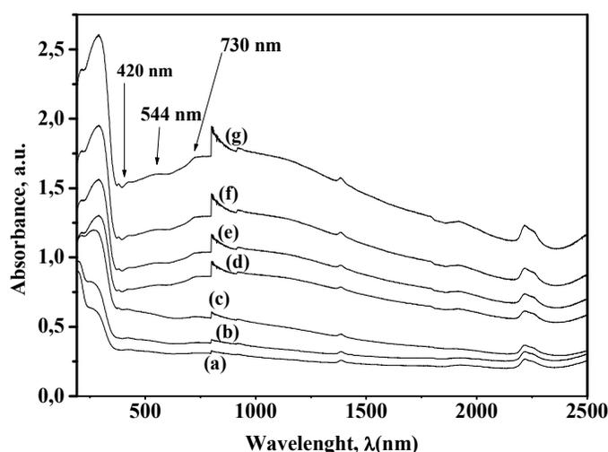
Fig. 3: DRS spectra of  $x\text{Ni}/\text{CaHAp}$  for: (a)  $x = 0$ ; (b)  $x = 0.5$ ; (c)  $x = 1.25$ ; (d)  $x = 2.5$ ; (e)  $x = 5$ ; (f)  $x = 10$ ; (g)  $x = 20$ .
