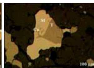
Fig. 9 : Images au microscope à réflexion d'une lame mince de la météorite de Benguerir montrant les lithologies sombre (D) et claire (L), de la chromite (cr), du métal (M), des sulfures (S), de la troilite (T) et du cuivre natif (Cu).
