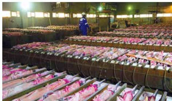
Cellules d'électrolyse où est déposé le cobalt une fois purifié
