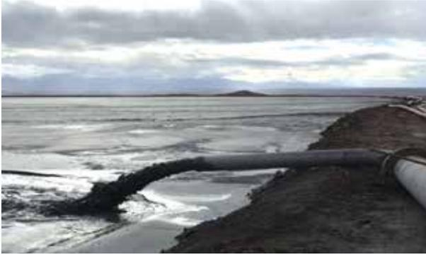
Tuyau déversant les stériles d'une laverie de flottation à Guemassa conduit à la formation d'une «digue»
