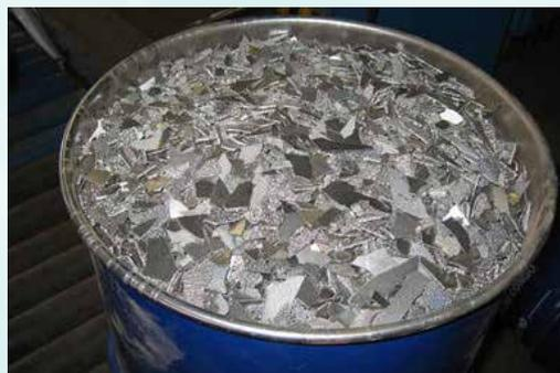
Cathode de cobalt de 1mx1m, découpée et déchetée: les clients qui font des super-alliages pour l'aéronautique ou qui fabriquent des batteries pour téléphone portables, voitures électriques, etc.. ont besoin de ce type de métal
