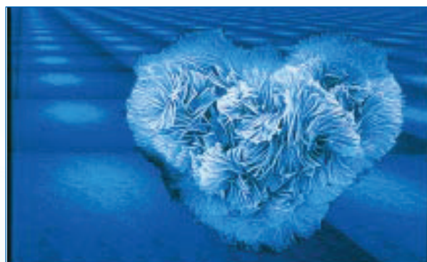
Sphérolite de polyéthylène formé par cristallisation en milieu supercritique. © CNRS, ICS - S. Graff
